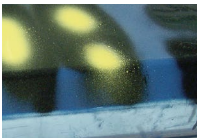
> Diffuseur avec surface revêtue, meilleure résistance aux acides, bases, produits d'entretien (revêtement anti-graffitis), Code art. 318 010
