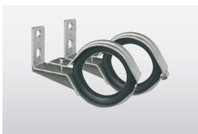
➤ Colliers de fixation en acier inoxydable V4A, avec équerre (la paire), (ne convient pas pour les atmosphères contenant du chlore), Code art. 770 118
