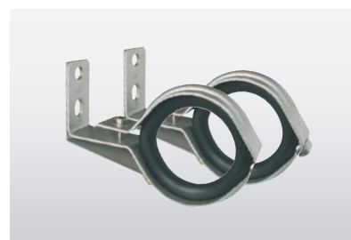
> Colliers de fixation pour BERN LED, acier inoxydable V4A, avec équerre (la paire), (ne convient pas pour les atmosphères contenant du chlore), Code art. 534 118
