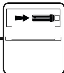
Insérer la nouvelle lampe dans les douilles.
