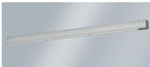
03 Das Tragsystem von NIGHTLINE besteht aus eloxierten Aluminium-Strangpressprofilen mit 152 x 186 mm Querschnitt. Die Länge der Profile ist auf die Aufnahme von drei Leuchtenmodulen abgestimmt (3 x Ausführung m1500).
